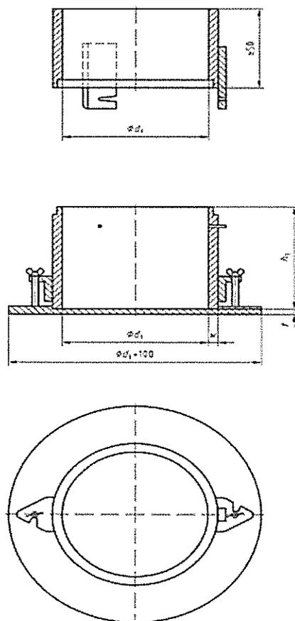
**Figure 2 – Schéma de principe du moule Proctor et de sa rehausse**
