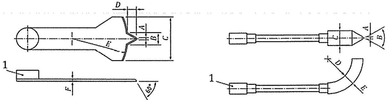
**Figure 2 : Outil à rainurer pour le dispositif Casagrande**
