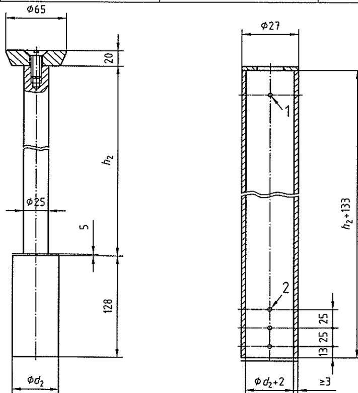
Figure 1 : Principe de la dame de compactage et du guidage
